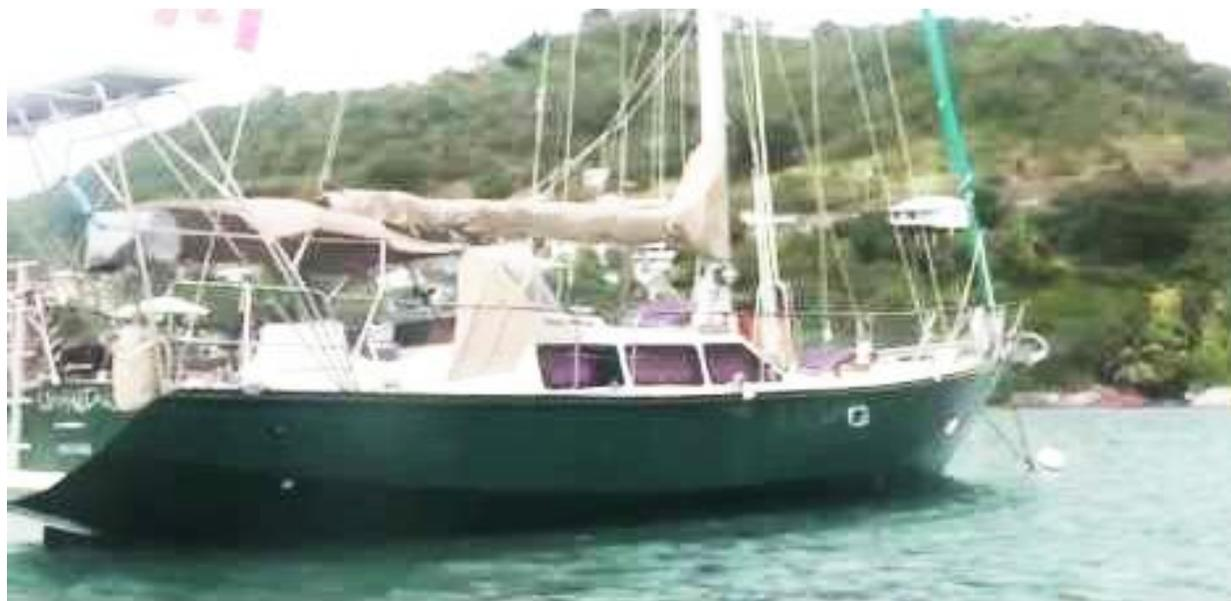
Notez le gréement cotre (de préférence à trinquette autovireuse) et l'intéressant abri intégral du cockpit, en toile, dont les côtés sont amovibles. Une idée spéciale froids d'Henk de Velde. A voir la tenue dans la durée.
